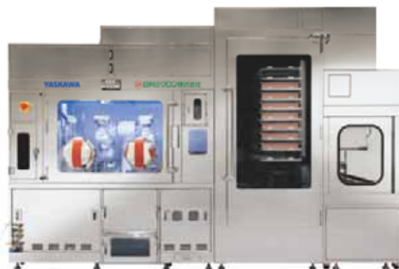
図3 オートメーション型抗がん薬調製支援装置の外観
